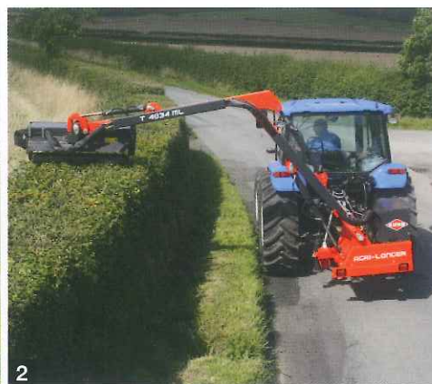
1 & 2. Auslege-Böschungsmulcher (links oder rechts) mit einer horizontalen Reichweite von bis zu 7,40 m. - 3. Salz- und Sandstreuer
