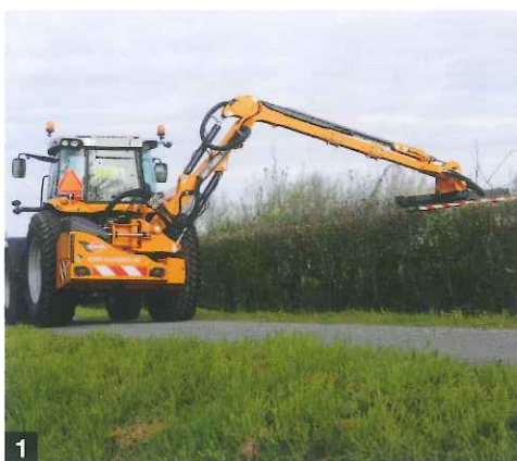
1 & 2. Auslege-Böschungsmulcher (links oder rechts) mit einer horizontalen Reichweite von bis zu 7,40 m. - 3. Salz- und Sandstreuer
