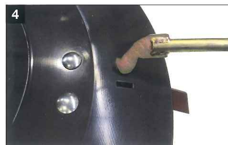
Messerwechselsystem mit Sonderwerkzeug und Messerhalter
