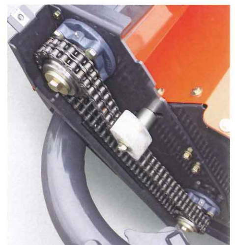
Die Aufbereiterdrehzahl (815 min -1 ) kann durch Austauschen der Zahnräder auf 650 min -1 reduziert werden
