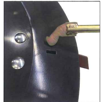
Schnellwechselsystem für die Messer
