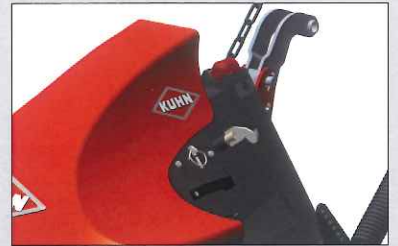
Flexibler FLEXTOP-Oberlenker (nur für starren Anbaubock geeignet)
