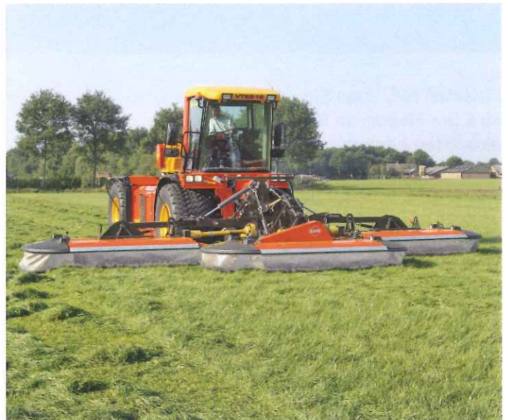
Mit geringfügigen Anpassungen und einem Montagesatz für das Frontmähdwerk lässt sich die Schmetterlingskombination auch in Schubfahrt einsetzen
