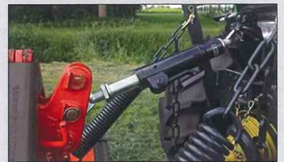
FRONTFLEX-Teleskop-Oberlenker (nur für schwenkbaren Anbaubock geeignet)
