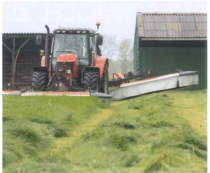
Einzelaushub der Mäheinheiten des PZ 960 durch serienmäßige Ausrüstung mit Mehrwegeventil
