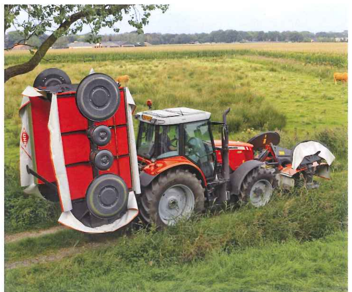
Zum Straßentransport werden die Mäheinheiten über einen Hydraulikzylinder hochgeschwenkt. Die Transportbreite liegt unter 3,00 m
