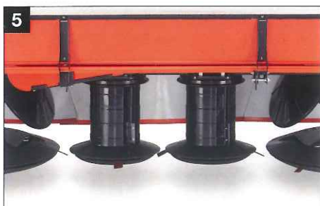
Serienmäßige Schwadscheiben für eine schmale Schwadablage
